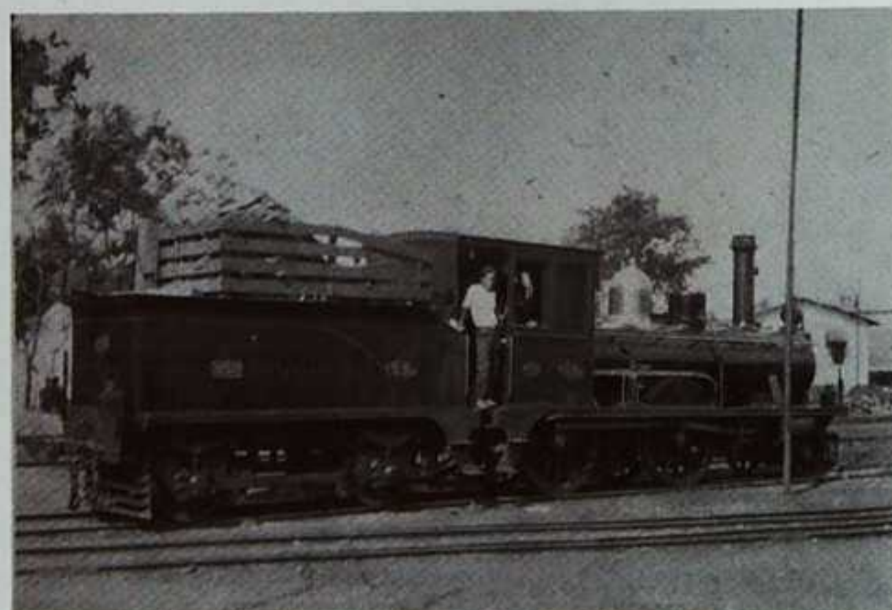
Een locomotief van de serie 200. 100 jaar geleden waren dit de sneltrein machines van de Staatsspoorwegen. Indienststelling 1881-1886. Deze machines werden met hout gestookt. Op de tender een krat om voldoende brandstof te kunnen meenemen.
