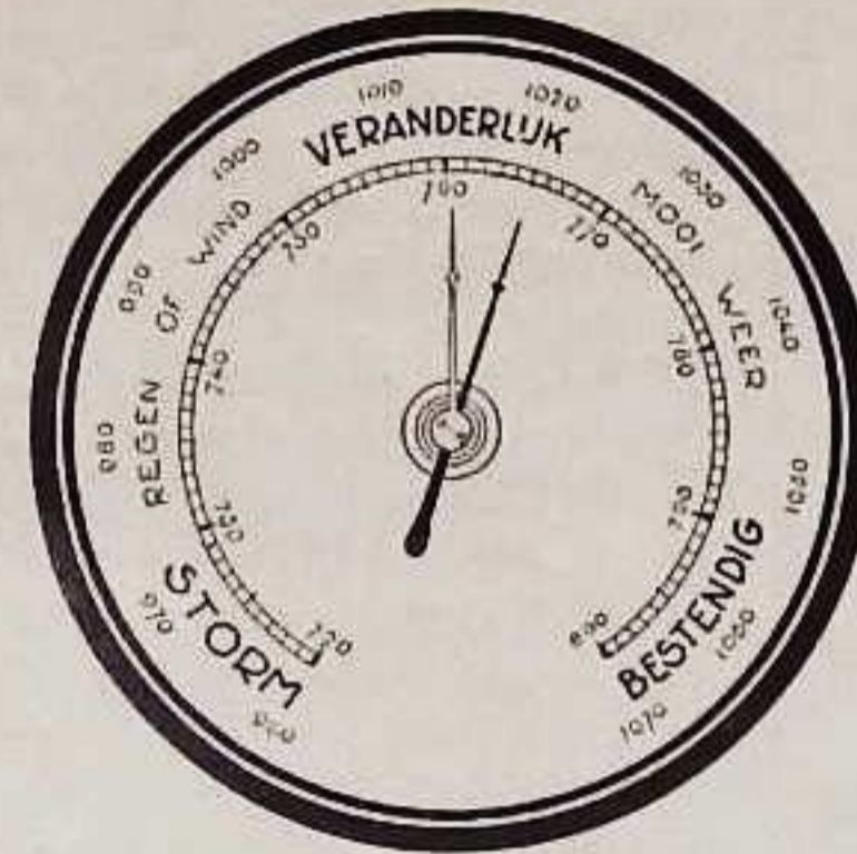
FIG. 106. DEZE BAROMETER GEEFT DE LUCHTDruk AAN IN MILLIMETERS EN IN MILLIBAREN
